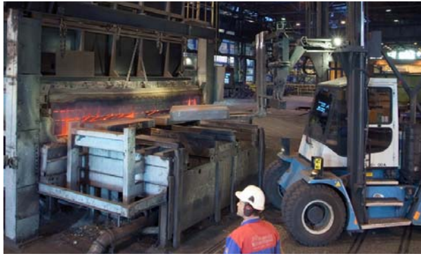
Figura 7. Com aumentos de 40-50% no rendimento , este forno laminador de placas existente na Outokumpu Stainless, Suécia, pode acumular volumes de produção de outro local.
