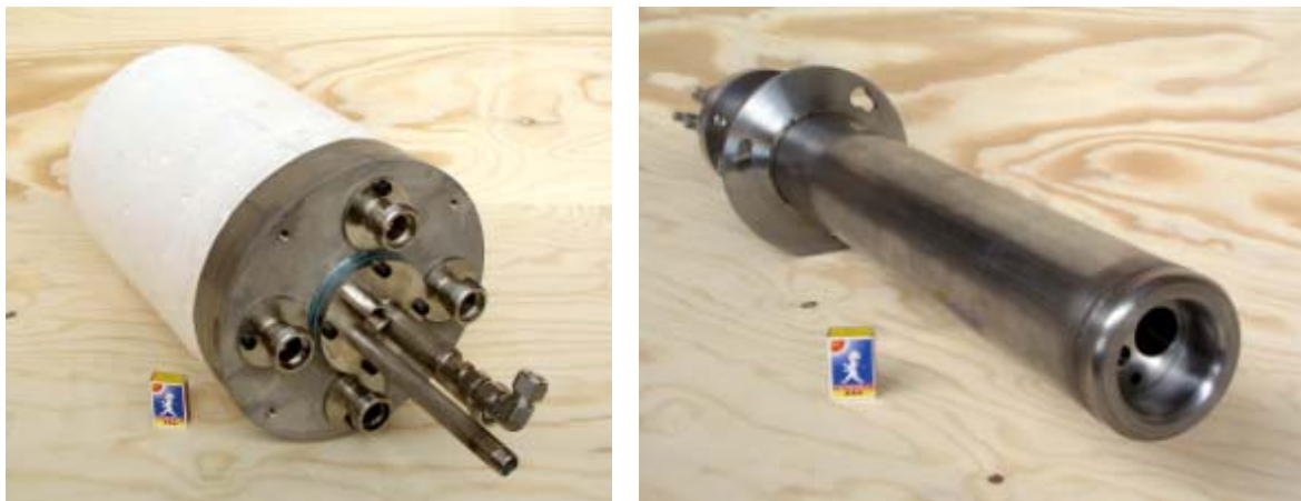
Figura 6. A figura à esquerda mostra um queimador de oxi-combustível cerâmico auto-refrigerado de 2 MW tipo sem chama. À direita, um queimador oxi-combustível tipo sem chama refrigerado a água, 0.5-5 MW. Ambos integram ignição e célula UV.
